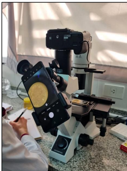
Figura 14. Microscopio Óptico Invertido con contraste de fases marca Olympus ® modelo CKX41 utilizado para el análisis cuantitativo de fitoplancton.
