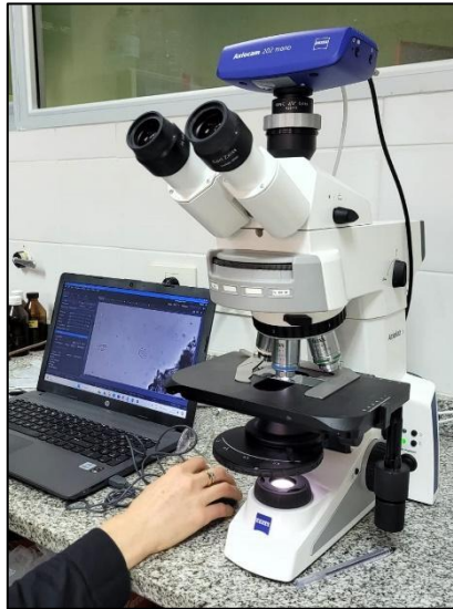
Figura 13. Microscopio Óptico de epifluorescencia marca Zeiss® modelo AxioLab 5 utilizado para fotografiar a las especies características del curso inferior del río Chubut.
