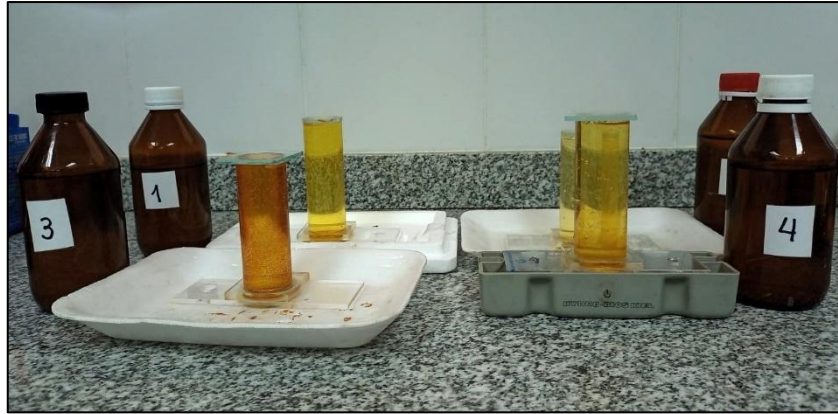
Figura 15. Cilindros de sedimentación con cámara utilizados para la sedimentación de las muestras cuantitativas de fitoplancton.
