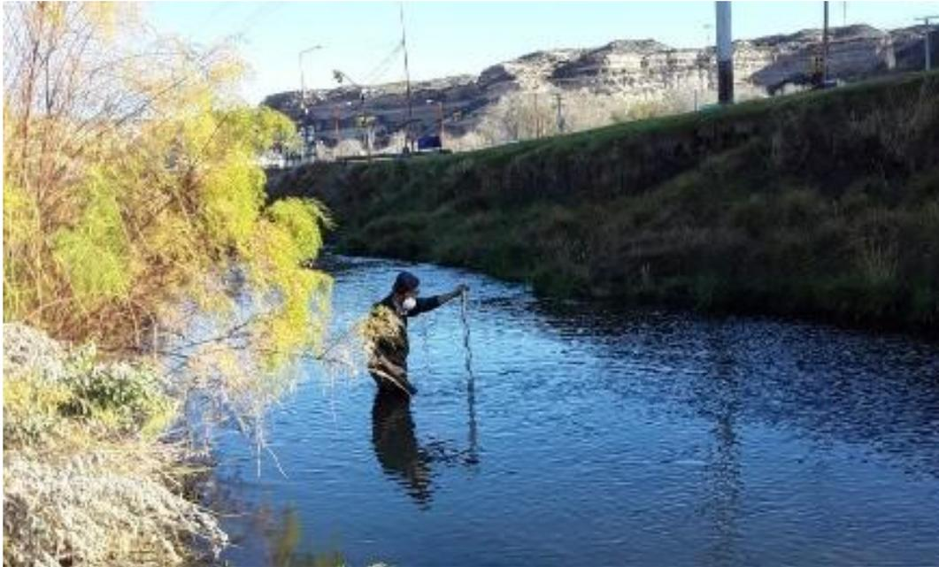
Figura 3.4. Medición de sección transversal del primer salado en agosto de 2020. Fuente: Elaboración propia, 2020.
