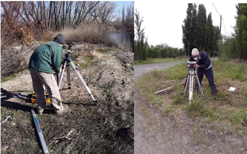
Figura 3.6. Estación central de nivelación en el Segundo Salado (nivelación en el CRyDVR). Fuente: Elaboración propia, 2020.
