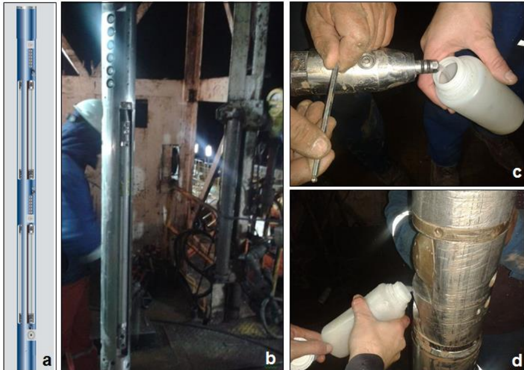
Figura 10: Esquema y fotografía del Multiensayador MDT (a, b), donde se observa una de las botellas de muestra; traspaso de la muestra de agua de una de las botellas al contenedor final (c); traspaso de la muestra de uno de los tanques (d).
