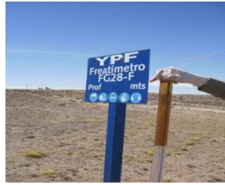
Espesor aparente de FLNA registrado en el pozo FG28-F (espesor aparente total registrado: 0,45 m)
