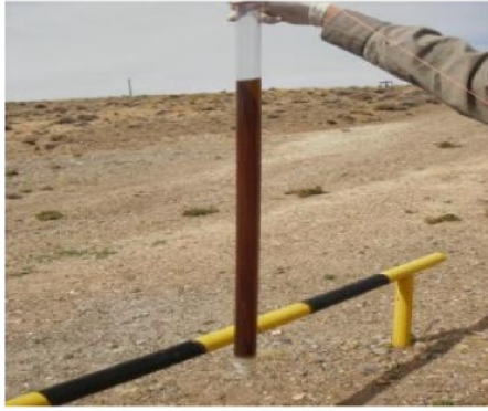
Espesor aparente de FLNA registrado en el pozo FG28-H, ubicado a menos de un metro del sistema de purga instalado (espesor total registrado: 0,94 m)
