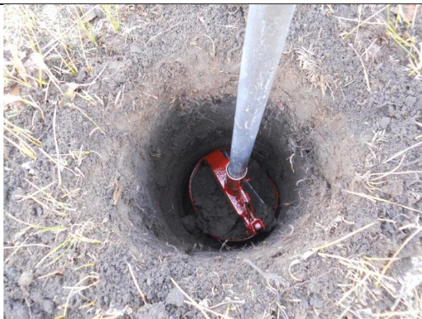
Imagen 7-Realización de pozo freático con pala vizcachera
